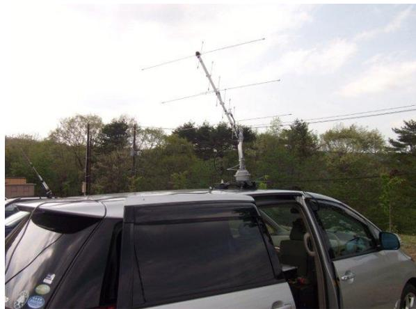
マグネット基台はすべて中古品を使用したもので、仕様と高さがバラバラです。このまま車両の天井に付けてしまうとかなり強力な力で、付け外しが大変です。最悪、天井が凹む可能性もあります。そこで、クッション材を必ず付けるようにします。アルミパネルはDIY店で入手し、角は危険なので丁寧にヤスリかけします。車内に引き込むケーブルは、筆者は、144MHzはマグネット基台のものをそのまま利用、430MHzは短くて太い中継ケーブルを別に使用しています。このあたりは好みで良いでしょう。ブームは32mmのアルミパイプを約30度曲げて使っていますが、さすがにこれは近所の鉄工所をお願いしました。
